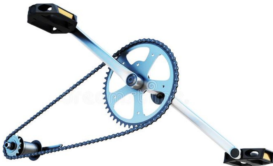
Fig. 11 Pedais de uma Bicicleta.
