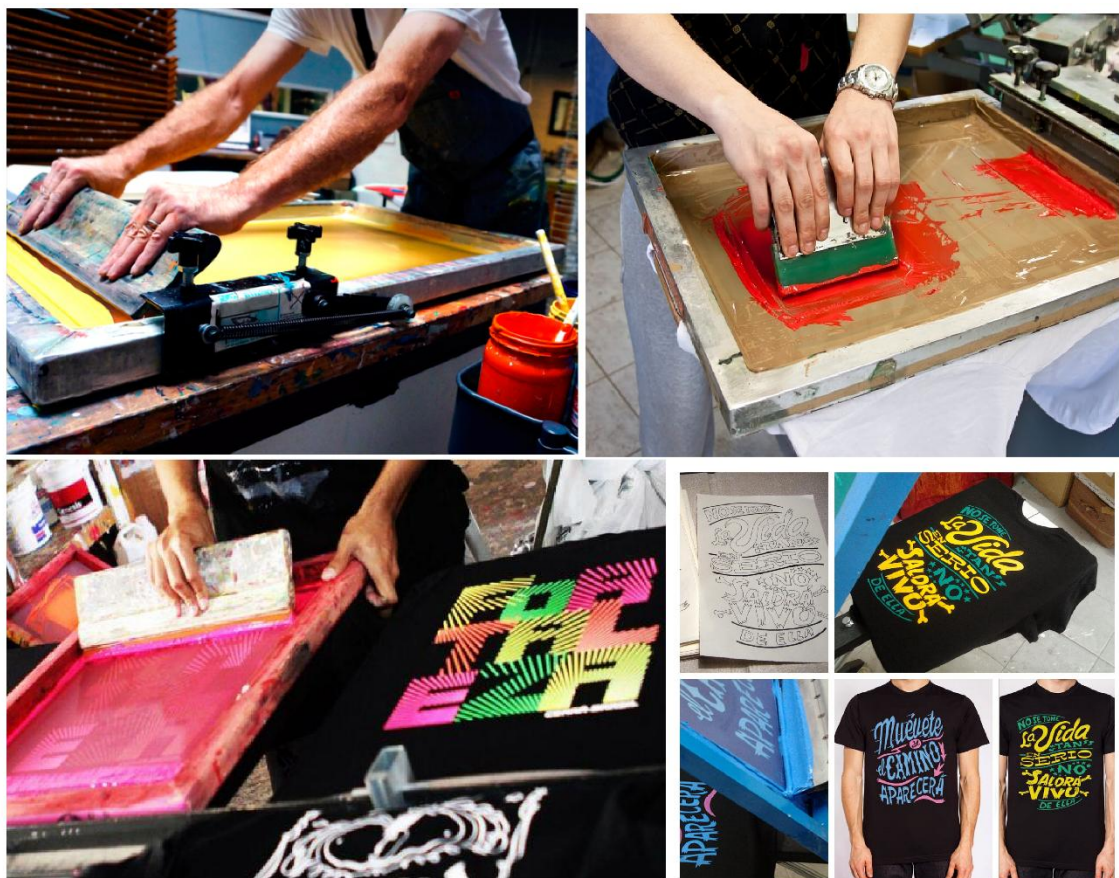
Fig.1 Procedimentos de produção de um trabalho serigráfico.
